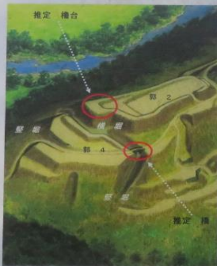
▲ 横矢がかり（推定橋と推定檜台）
