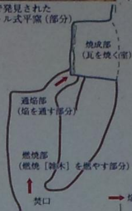
図2 ロストル式平窯の構造
