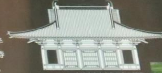
上醍醐寺金堂復元南立面図 (屋根が付いた状態の想定図)
